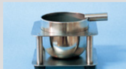
Elektrolytický pohárek pro měření drátů a malých částí.
